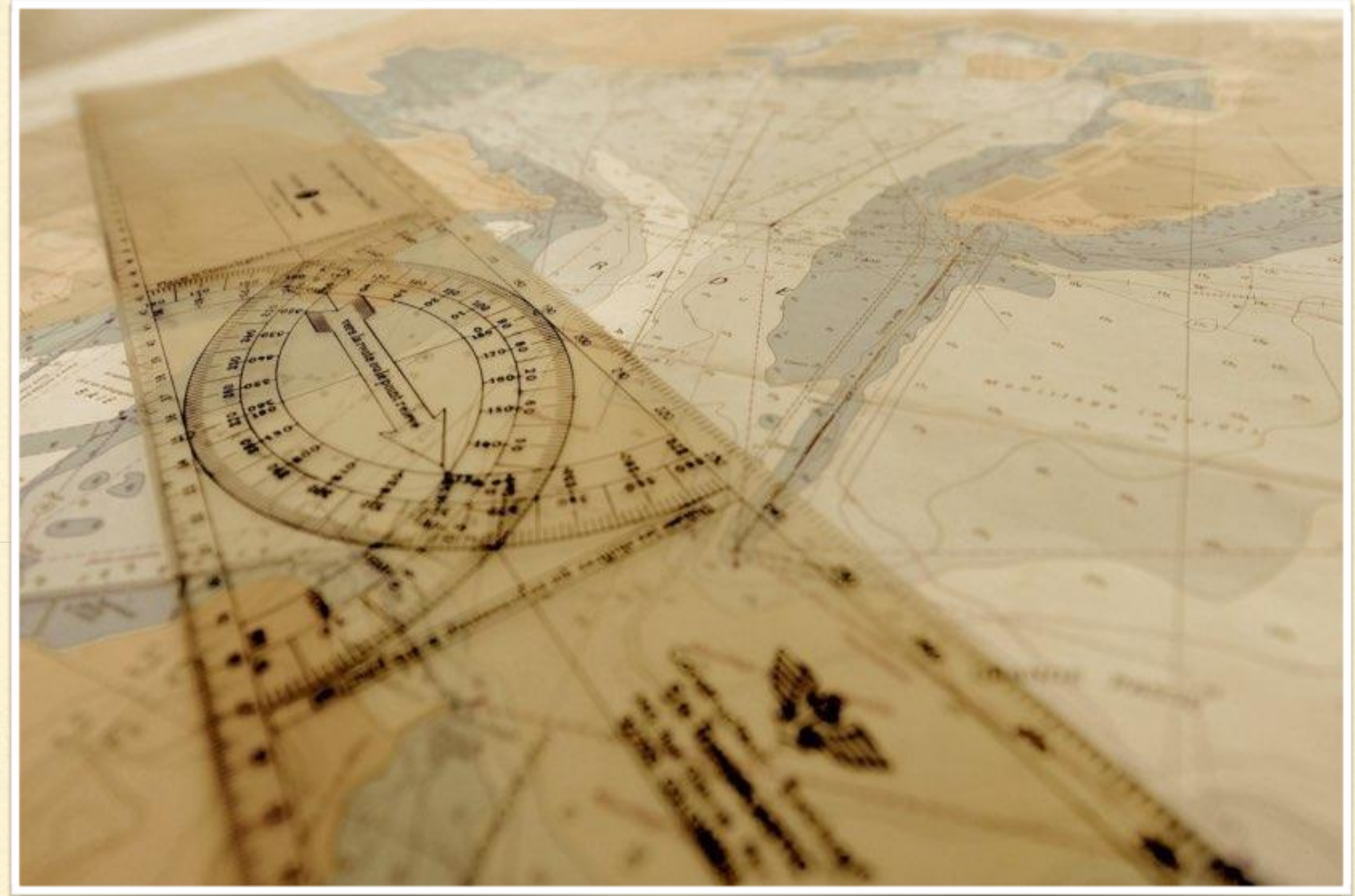
La règle Cras, très largement utilisée par les navigateurs pendant près d'un siècle, n'a que très récemment été supplantée par le GPS.
